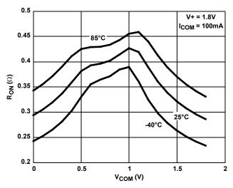
FIGURE 13. ON RESISTANCE vs SWITCH VOLTAGE
