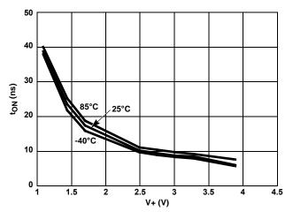
FIGURE 17. TURN-ON TIME vs SUPPLY VOLTAGE
