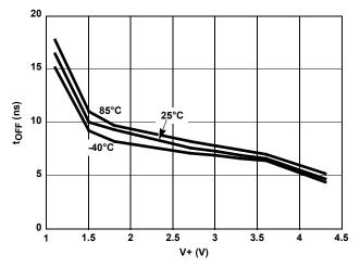
FIGURE 18. TURN-OFF TIME vs SUPPLY VOLTAGE
