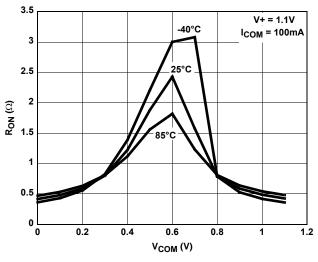
FIGURE 14. ON RESISTANCE vs SWITCH VOLTAGE
