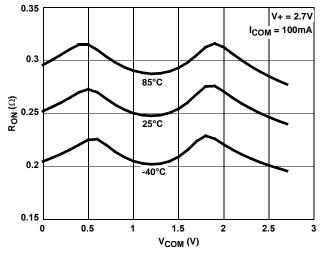
FIGURE 12. ON RESISTANCE vs SWITCH VOLTAGE
