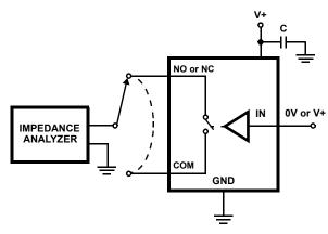
FIGURE 7. CAPACITANCE TEST CIRCUIT
