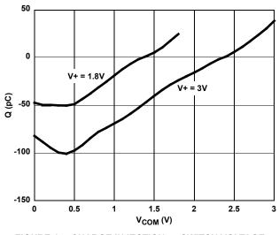
FIGURE 15. CHARGE INJECTION vs SWITCH VOLTAGE
