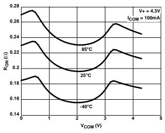
FIGURE 11. ON RESISTANCE vs SWITCH VOLTAGE
