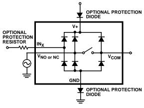
FIGURE 8. OVERVOLTAGE PROTECTION
