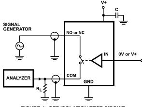
FIGURE 4. OFF ISOLATION TEST CIRCUIT
